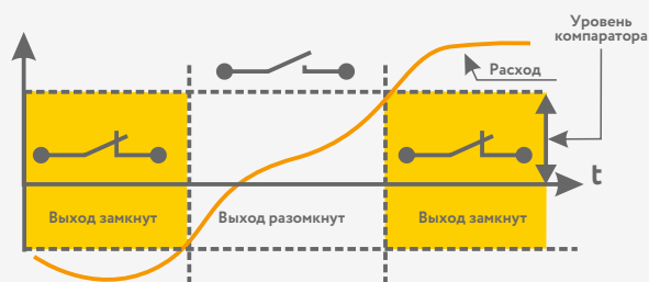
Компаратор порога по модулю
