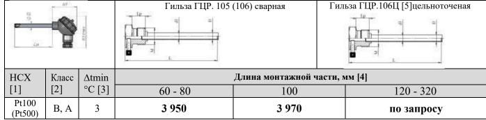
Схема заказа: КТС-Б- [1]-[2]-х4-П-[3]-[4]/6-50-[5]\*-Е \*[5]- ГЦР.106Ц -Указывается только для длин от 200 до 320 мм. Пример: КТС-Б-Рт100-В-х4-П-3-220/6-50-ГЦР.106Ц-Е
